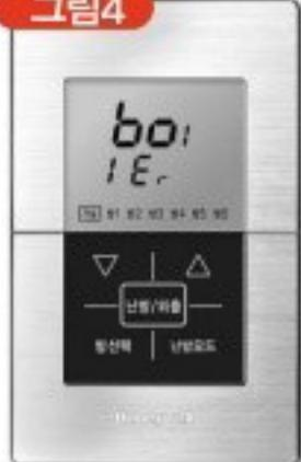
보일러에러 발생시 화면이 그림4와 같이 표시됩니다. 이때는 보일러 에러코드를 참조하시기 바랍니다. (보일러 에러코드를 수신하여 "boiler"와 에러 코드를 번갈아 표시)
